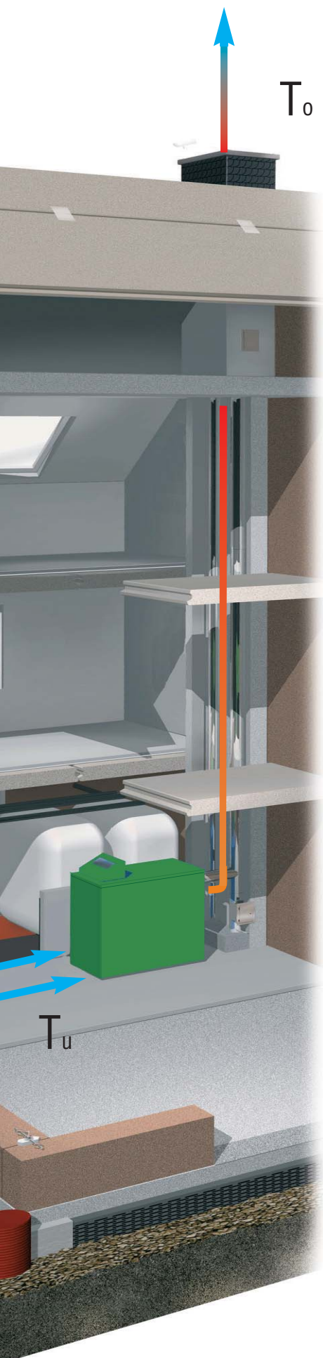
Abströmverluste durch das Abgassystem
