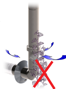
Fig. 11 : Maintenir l'entrée d'air de combustion libre
