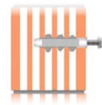
Abb. 8: Beispiel, Injektionsankerbefestigung bei Mauerwerk
