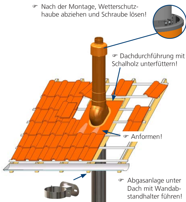
Abb. 13: Schrägdach mit typischer Dachhochführung
