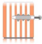
Abb. 8: Beispiel, Injektionsankerbefestigung bei Mauerwerk
