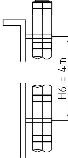
**Aufbauhöhen DW-Alkon****Feuerungsanschluß 87° DHF90****Maximale Aufbauhöhe Boden - Mündungsabschluß; alternativ Boden - 1. Wandkonsole**
