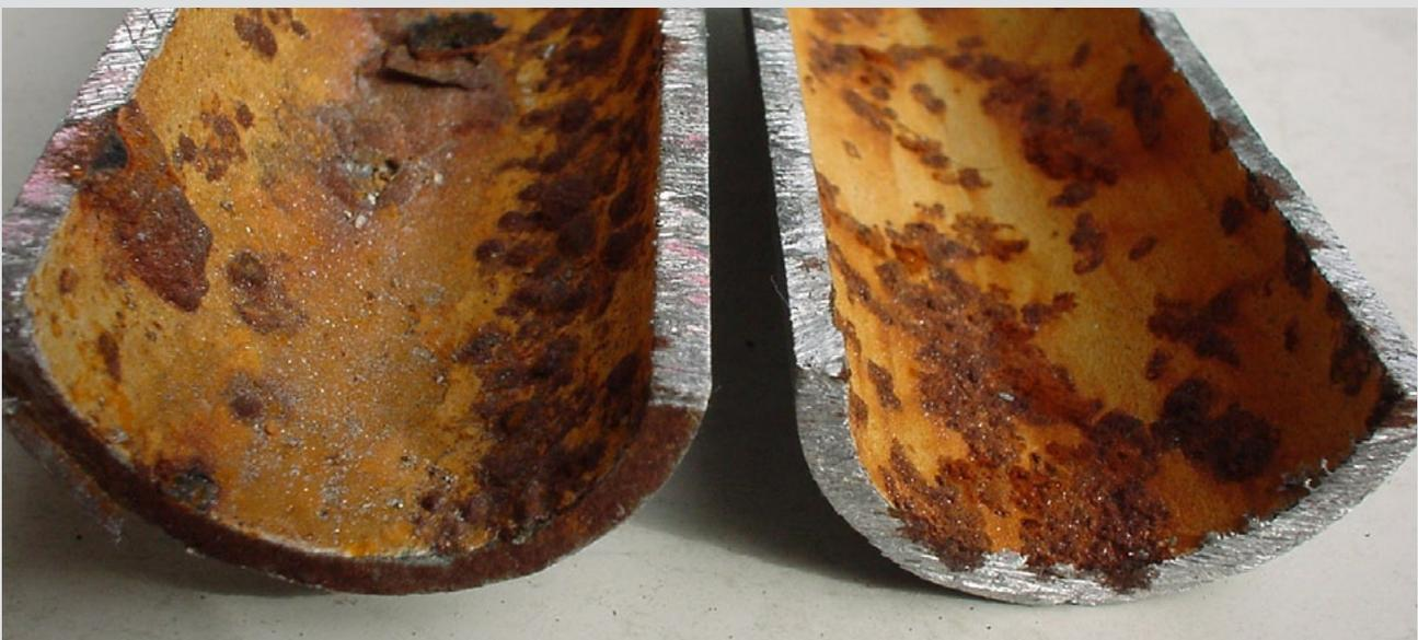
Bild: Korrosion in Heizungsrohren
