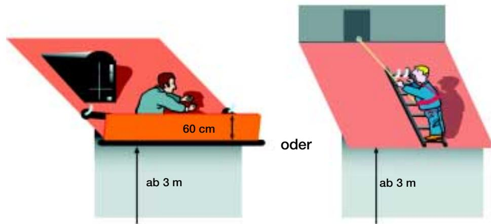
◆ Bei einer Dachneigung von mehr als 60°
