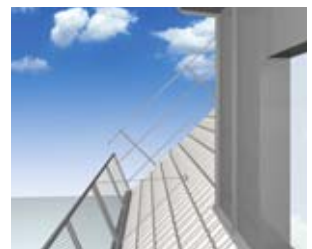
4 Fest installierte Dachfangwand und Giebelschutz auf bestehendem Dach
