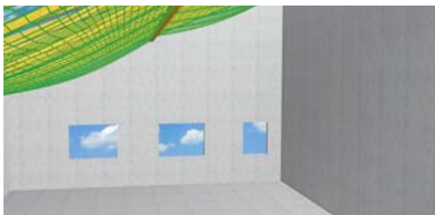
1 Direkt unter den Dachsparren eingebautes Auffangnetz
