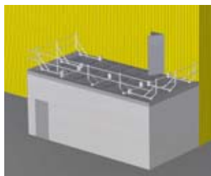
2 Flachdach mit temporärem Seitenschutz
