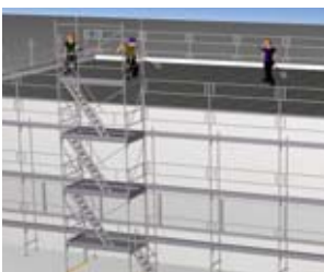
1 Flachdach mit Spenglergang
