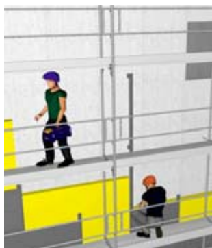
Regel 6 Fassadenarbeiten mit sicheren Arbeitsmitteln.
