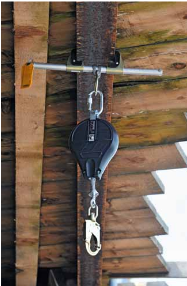
Bild 22 An mobilem Anschlagpunkt montiertes Höhensicherungsgerät.
