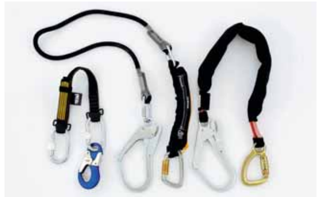
Bild 10 Aufreißband, als Falldämpfer in ein Halteseil eingebaut. Bei einer Belastung von etwa 3 kN (300 kg) beginnt das Band aufzureissen.
