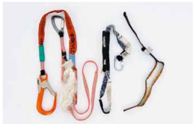
Bild 11 Beispiele aufgerissener Falldämpfer. Das Aufreissen dämpft den Fallstoss.
